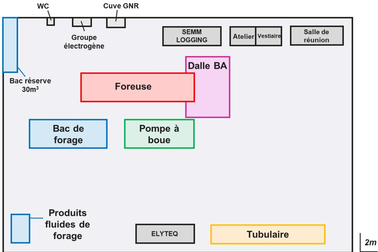
Implantation prévisionnelle du site de forage (25m x 40m, soit 1000 m<sup>2</sup>) - L'implantation est donnée à titre indicatif et pourra être modifiée en fonction des installations des prestataires (SEMM LOGGING, ELYTEQ, etc.)
