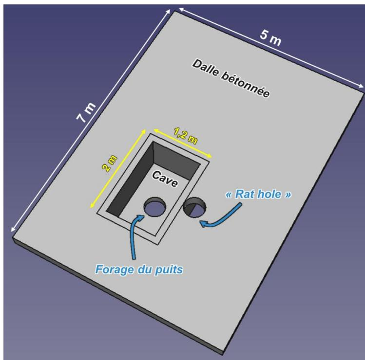
Schéma de la dalle en béton armée envisagée pour la plateforme de forage - Les mesures sont données à titre indicatif et pourront être modifiées si besoin
