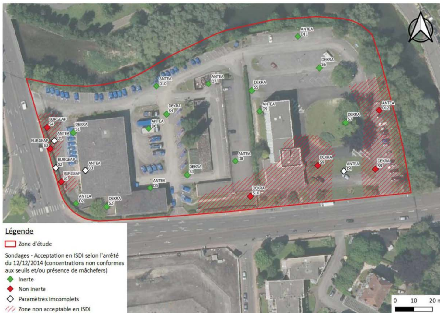
Figure 19 : Caractérisation des terres analysées selon l'arrêté du 12/12/2014 relatif à l'orientation des terres en filière de type ISDI – Synthèse des études réalisées.
