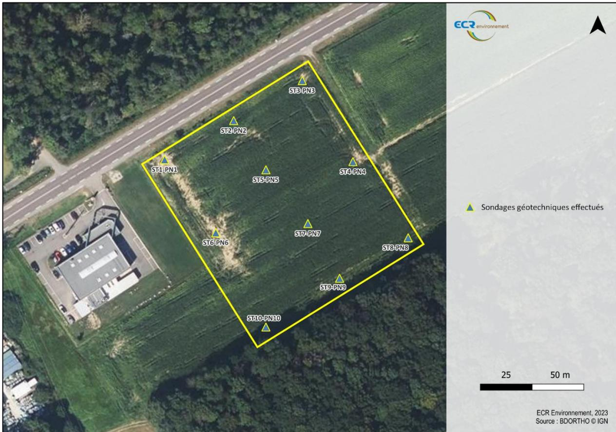
Figure 13 : Implantation des sondages géotechniques – ECR Environnement, 2022
