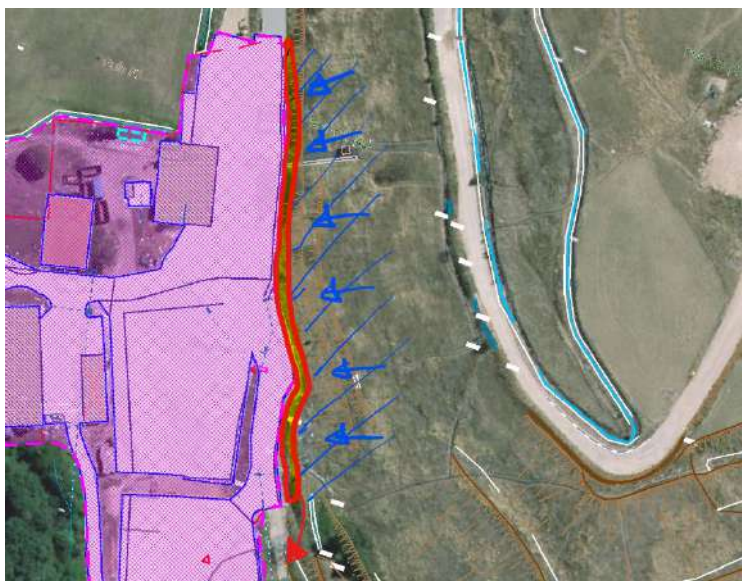
Figure 18 : Schéma de principe déconnexion EP issues de l'ISDND – Talus Nord-Est
