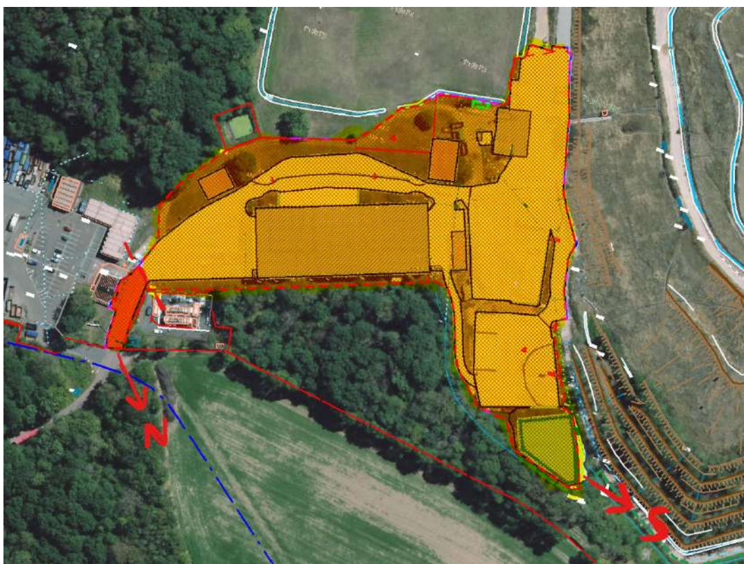
Figure 20 : Schéma de principe sous-bassins versants projetés
