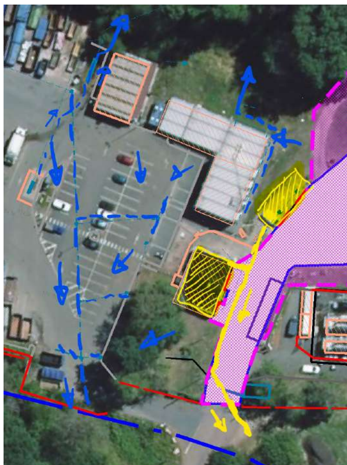
Figure 6 : Schéma de principe écoulements limite Nord
