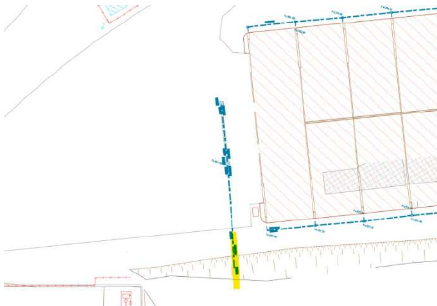
Figure 13 : Extrait géodétection – Rejet Nord-Ouest existant
