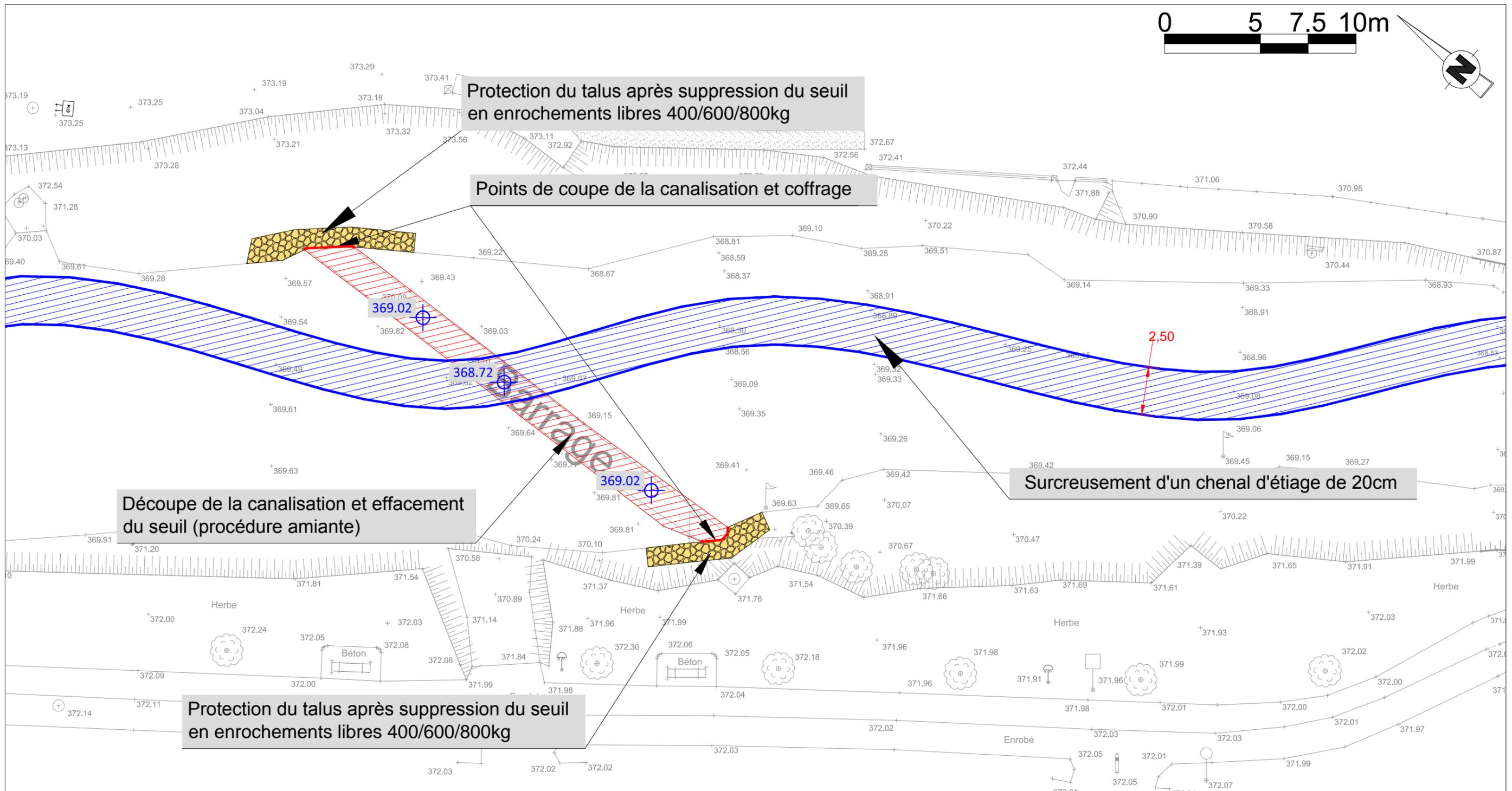
Découpe de la canalisation et effacement du seuil (procédure amiante)
