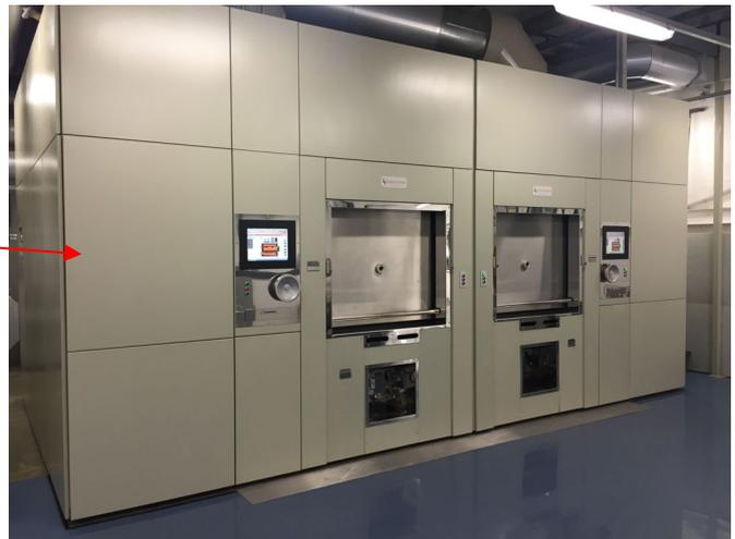
Refroidisseur : 1 500 à 2 000 m<sup>3</sup> de gaz à 850°C produits par la combustion du cercueil et de son contenu feront l'objet d'un refroidissement instantané pour permettre à basse température (150°C) d'être traités par la méthode de l'adsorption et filtrés. Aujourd'hui, nous préconisons que chaque appareil de crémation soit doté de son propre refroidisseur procurant au process souplesse d'exploitation et efficience.
