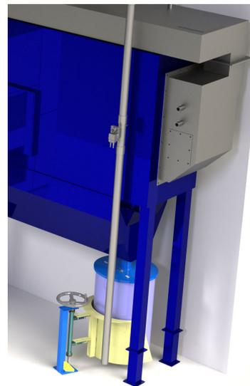
A l'issue de la filtration, les effluents piégés par le neutralisant et amalgamés sur les manches filtrantes du filtre simple seront décolmatés en fin de cycle (le soir) ou en cours de cycle (rarement) lorsque la perte de charge devient trop forte. Les filtrats collectés migreront alors dans un réceptacle de stockage de 60 ou 200 litres (selon la place disponible).
