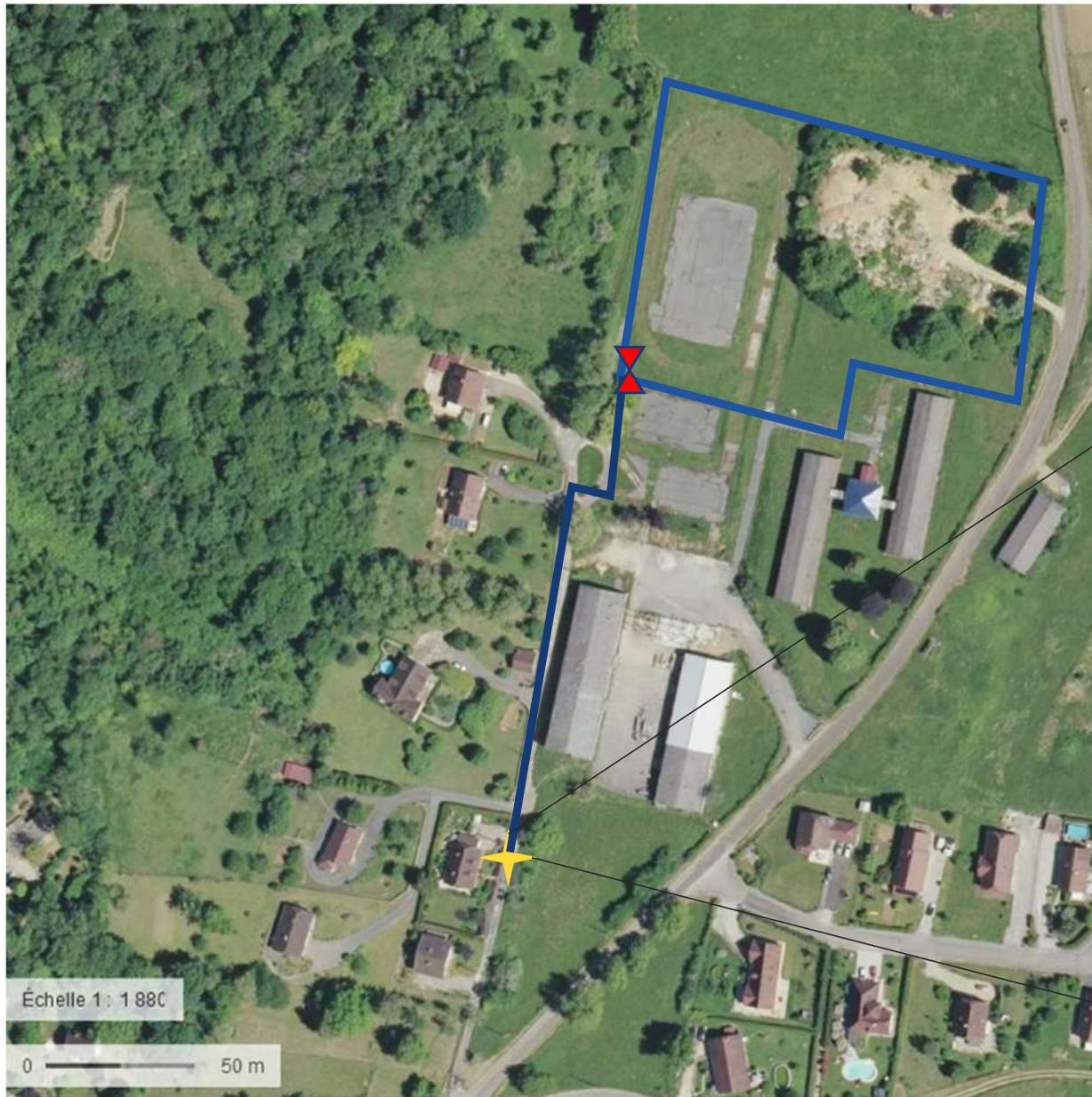
Pour raccorder l'installation photovoltaïque, nous créerons une ligne souterraine depuis le projet pour atteindre une ligne HTA. 116m de ligne souterraine seront créés.
