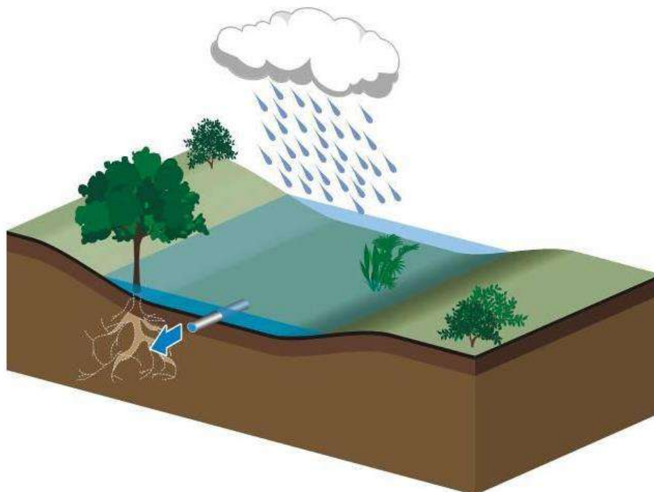
Figure 18 : Schématisation d'une noue drainée - (Architecture et Climat)
