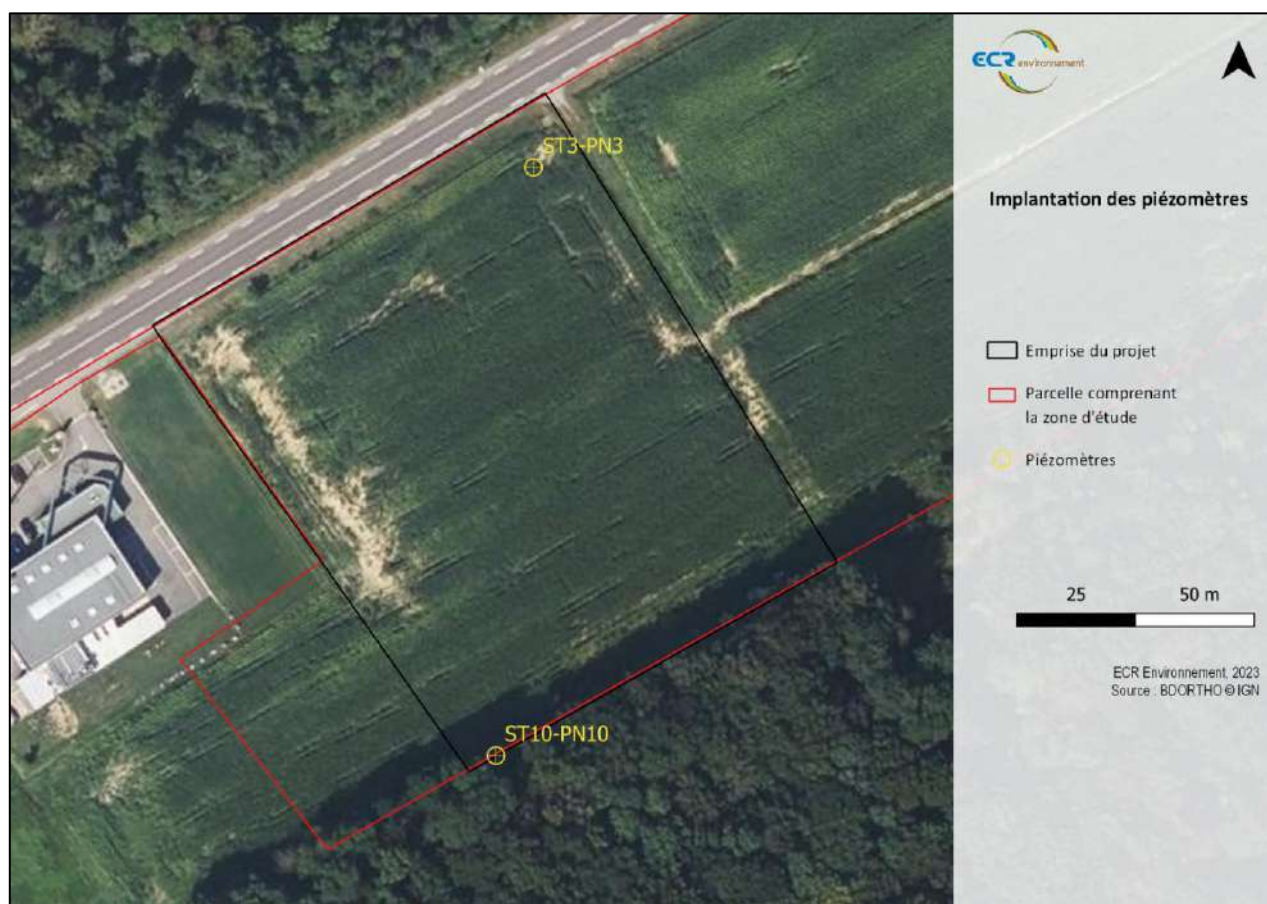
Figure 14 : Plan d'implantation des piézomètres - IGN
