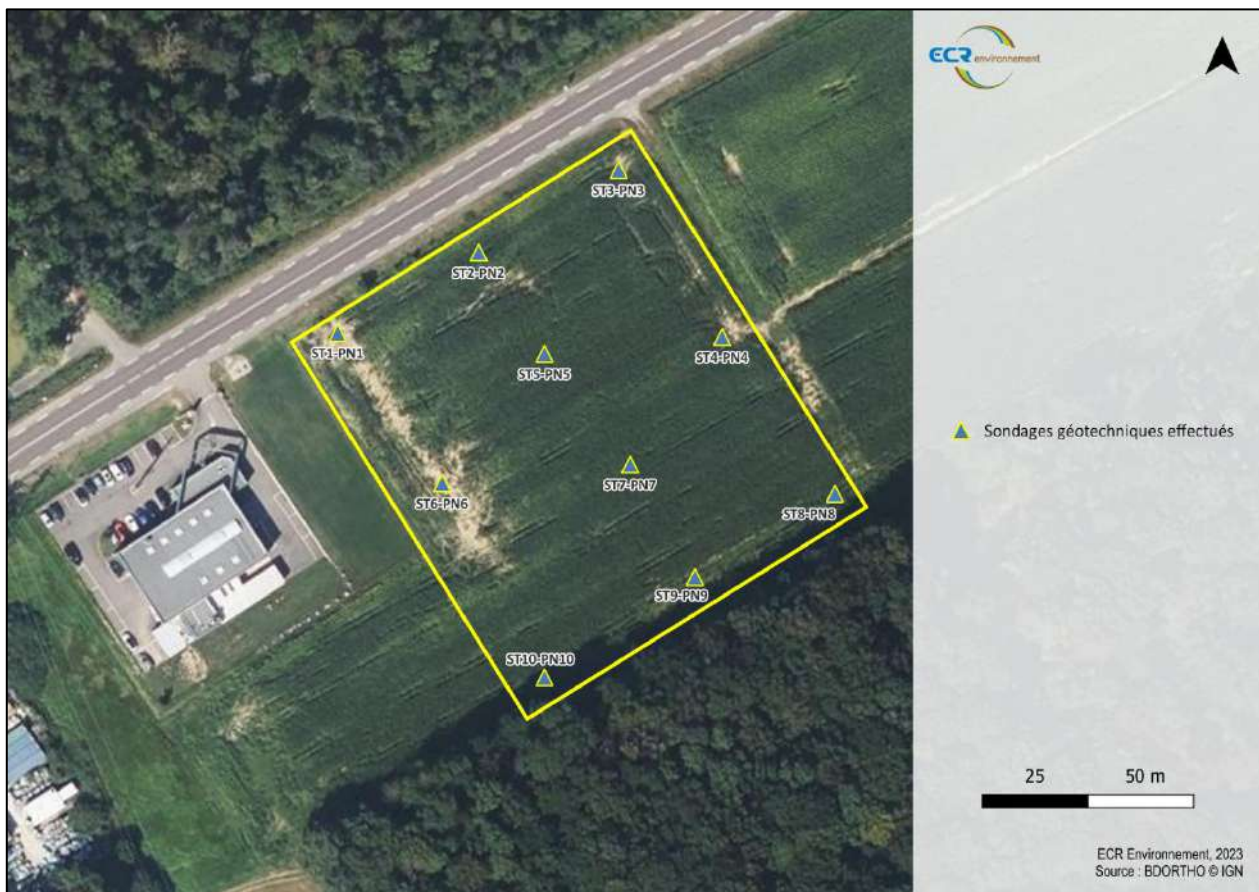
Figure 13 : Implantation des sondages géotechniques – ECR Environnement, 2022
