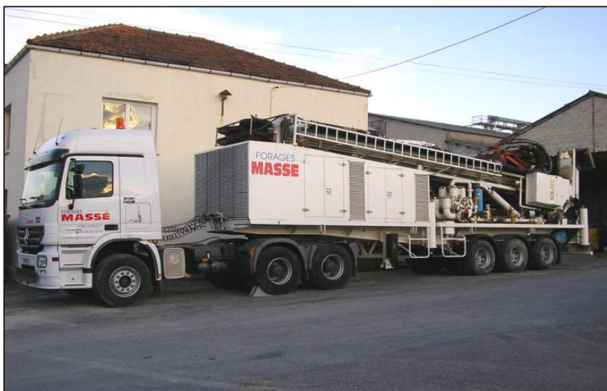
Figure 23 : Photographie de la foreuse G75 (MASSE FORAGES) qui sera mobilisée pour la campagne de forage de 45-8 ENERGY
