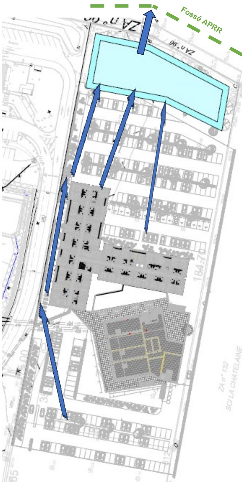
Au Nord les eaux sont retenues, s'infiltrent et s'évaporent dans un bassin à ciel ouvert peu profond et végétalisé. Un rejet est prévu au fossé APRR bordant le Nord de la parcelle, calibré à 7l/s.
