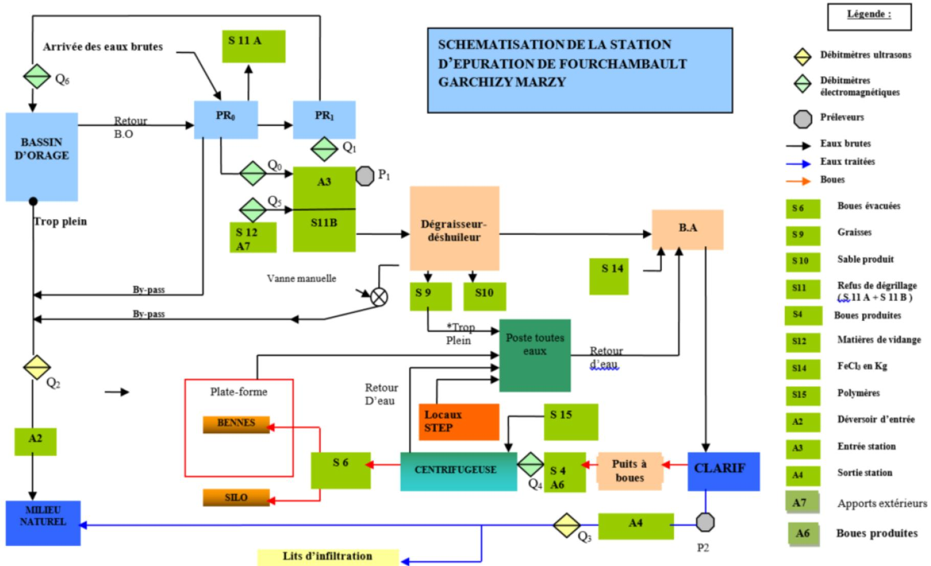
Figure 3 : Schéma de fonctionnement de la station d'épuration
