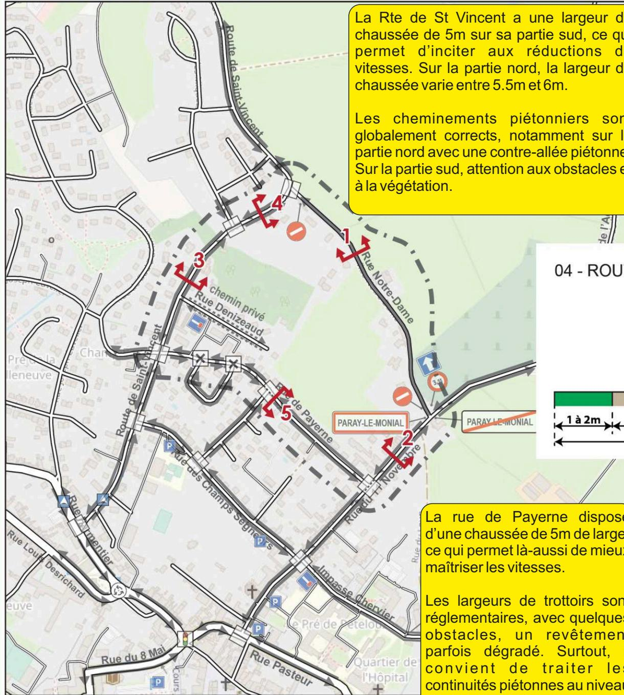
La Rte de St Vincent a une largeur de chaussée de 5m sur sa partie sud, ce qui permet d'inciter aux réductions de vitesses. Sur la partie nord, la largeur de chaussée varie entre 5.5m et 6m.
