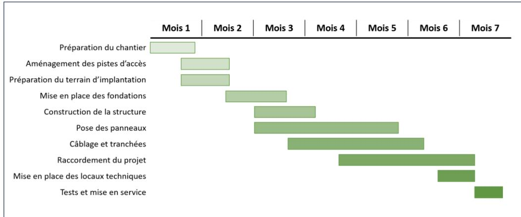
Figure 7 : Planning prévisionnel des différentes phases du chantier (entre 5 et 7 mois de chantier)
