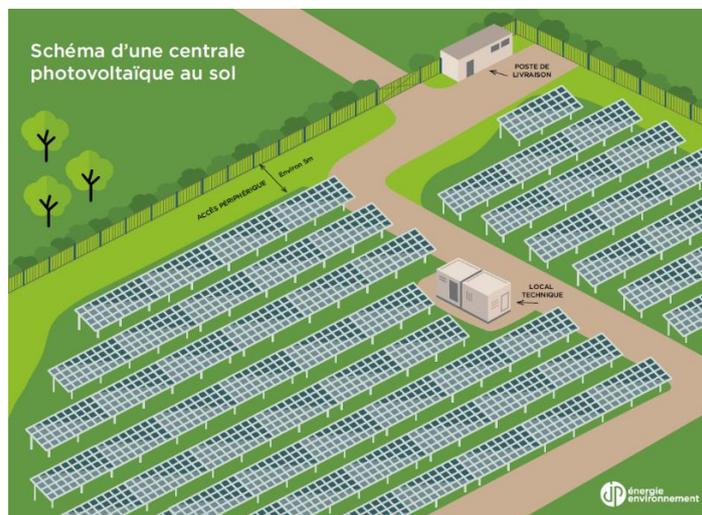
Figure 8 : Schéma d'une centrale photovoltaïque au sol (source : JPee)
