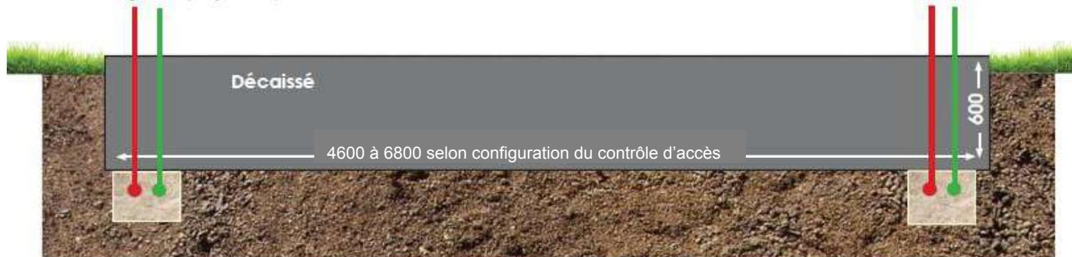
4- Pose géotextile + stabilisé + soit 200 mm de béton ou 80 à 100 mm de bitume
