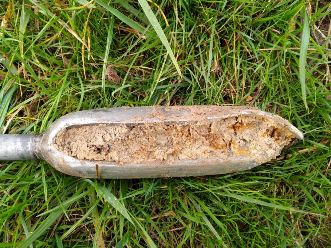
Illustration 11 : Traces d'oxydation au sein d'un sondage pédologique réalisé sur site
