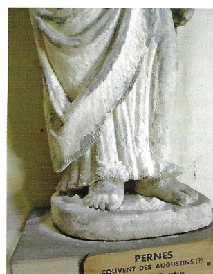
Désagrégation granulaire de la pierre contaminée par des sels hygroscopiques et soumise à des variations thermohydriques ambiantes. Statue de sainte Barbe, collection lapidaire du musée de Carpentras.
