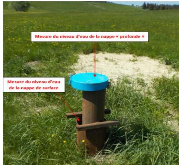
Figure 10 : Illustration de la mesure du niveau d'eau des 2 nappes sur les forages du Talonard
