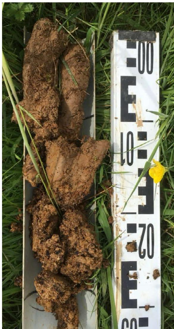
**Remarque** : Les traits d'hydromorphie ont été visualisés à moins de 25 cm de profondeur et se poursuivent en profondeur. Le sol observé dans ce sondage a les caractéristiques d'un sol humide.
