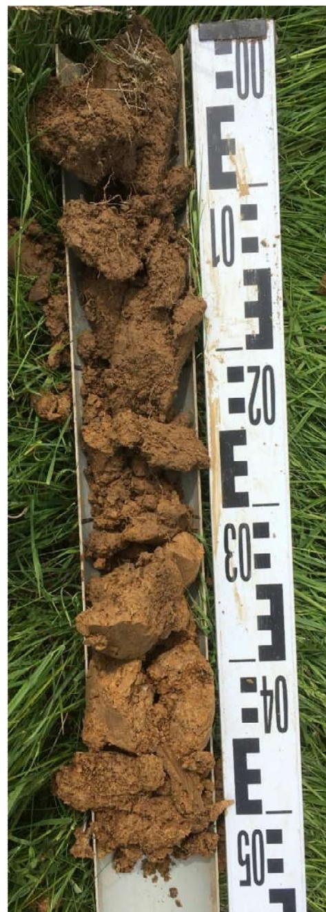
**Remarque** : Les traits d'hydromorphie ont été visualisés à moins de 25 cm de profondeur et se poursuivent en profondeur. Le sol observé dans ce sondage a les caractéristiques d'un sol humide.
