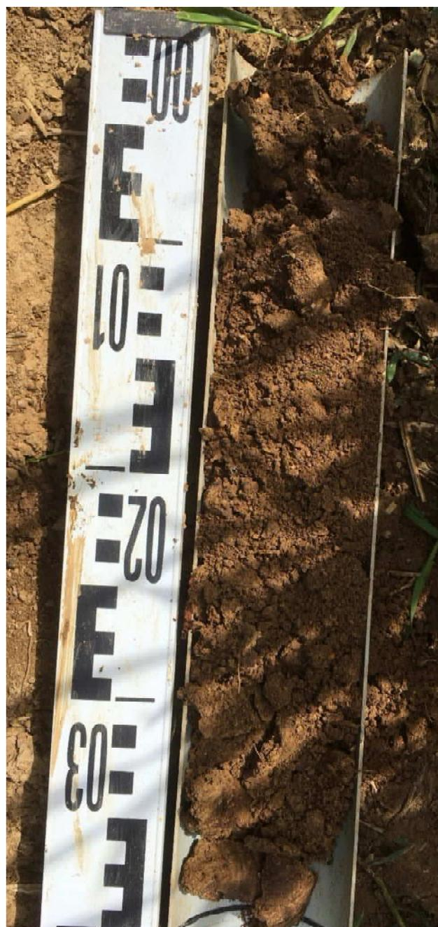
**Remarque** : Les traits d'hydromorphie ont été visualisés à moins de 25 cm de profondeur et se poursuivent en profondeur. Le sol observé dans ce sondage a les caractéristiques d'un sol humide.
