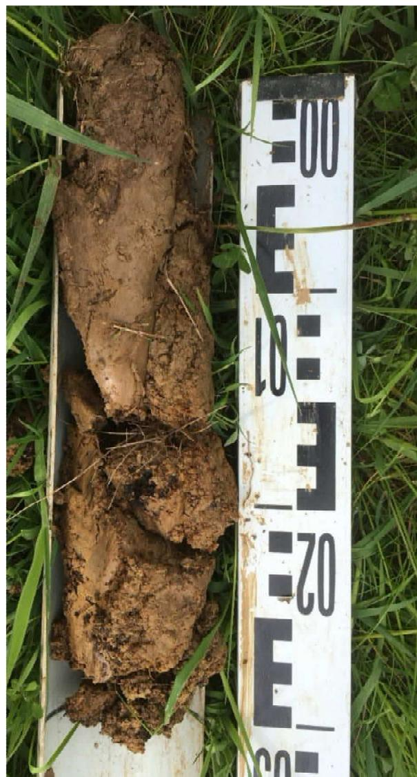
**Remarque** : Les traits d'hydromorphie ont été visualisés à moins de 25 cm de profondeur et se poursuivent en profondeur. Le sol observé dans ce sondage a les caractéristiques d'un sol humide.
