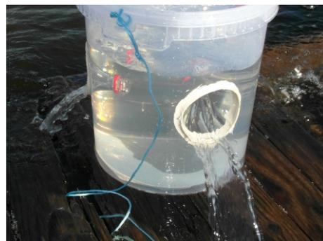
Il faut percer à la perceuse des trous de diamètre 1 mm sur la partie haute du seau et ne pas descendre sous le niveau des goulots pour garder le volume d'eau au fond.
