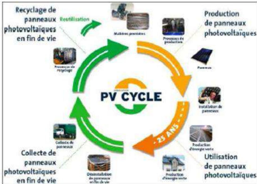
Figure 63 : Analyse du cycle de vie des panneaux PV en silicium cristallin (source : PV Cycle)
