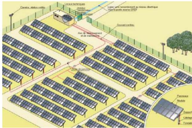
Figure 1 - Principe d'implantation d'une centrale solaire
