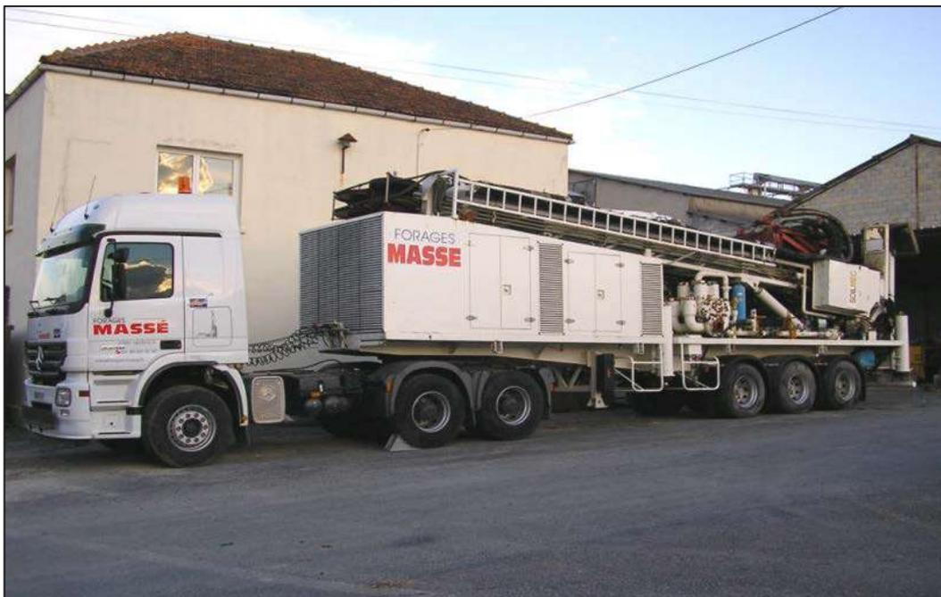
*Figure 22 : Photographie de la foreuse G75 (MASSE FORAGES) qui sera mobilisée pour la campagne de forage de 45-8 ENERGY*
