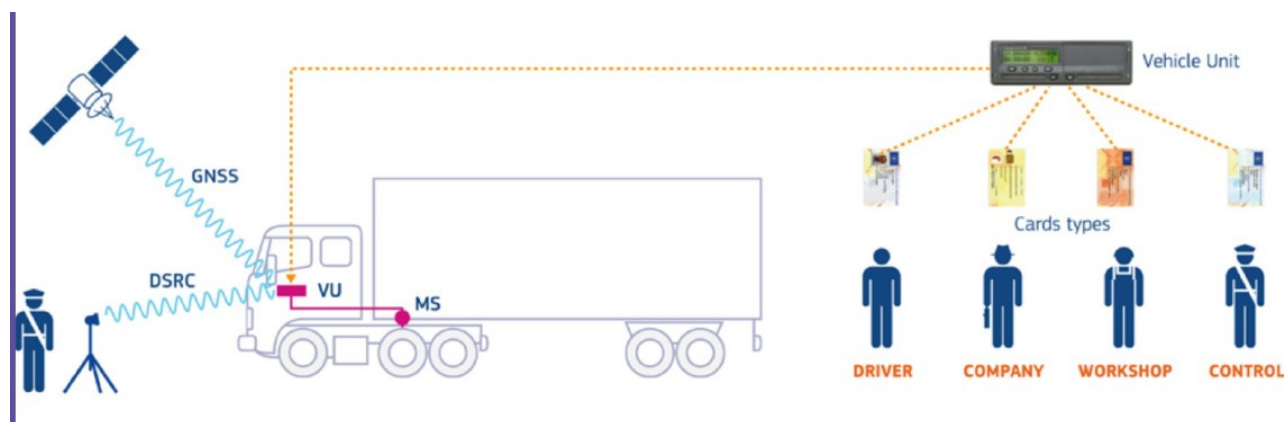
Le chronotachygraphe intelligent et ses composants
