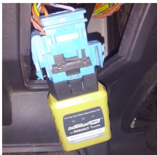
Exemples d'émulateurs destinés à « tromper » le système Ad-Blue
