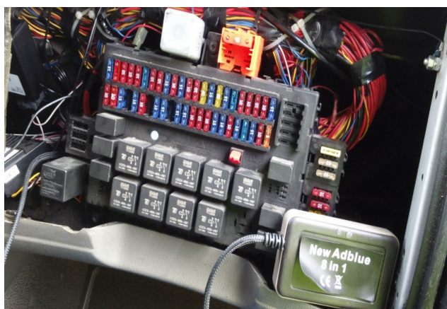
Exemples d'émulateurs destinés à « tromper » le système Ad-Blue
