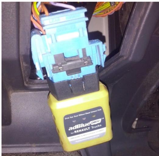
*Émulateur branché sur la prise OBD (On Board Diagnostic) du véhicule*
