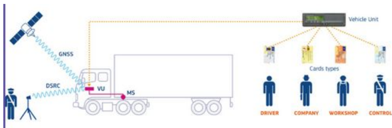
Le chronotachygraphe intelligent et ses composants
