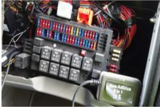
Exemples d'émulateurs destinés à « tromper » le système Ad-Blue
