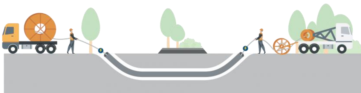
Figure 9 : Schéma de réalisation d'un forage dirigé en sous-œuvre (Source : RTE-france.fr)
