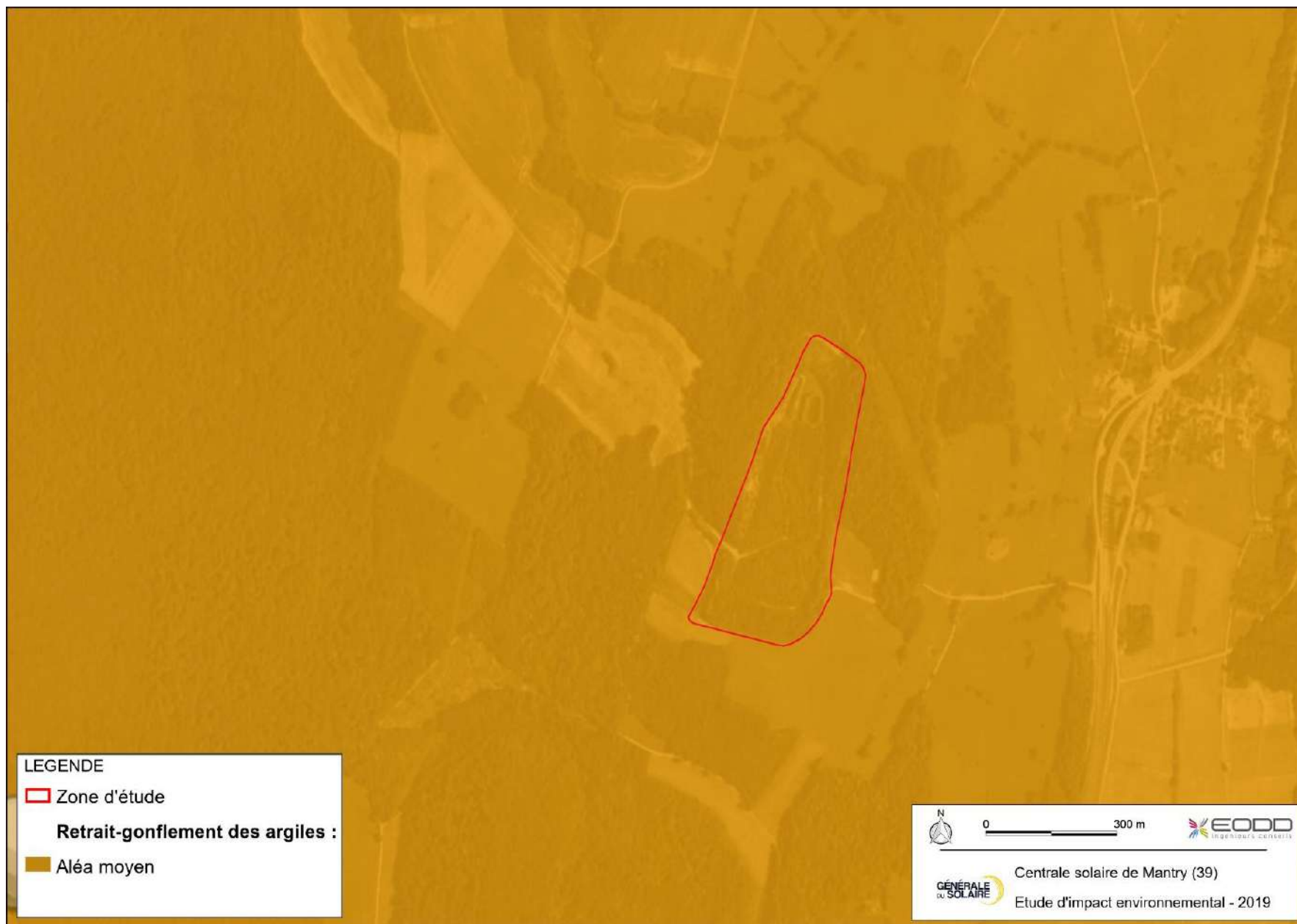
Figure 39 : Localisation de la zone d'étude et aléa retrait-gonflement des argiles
