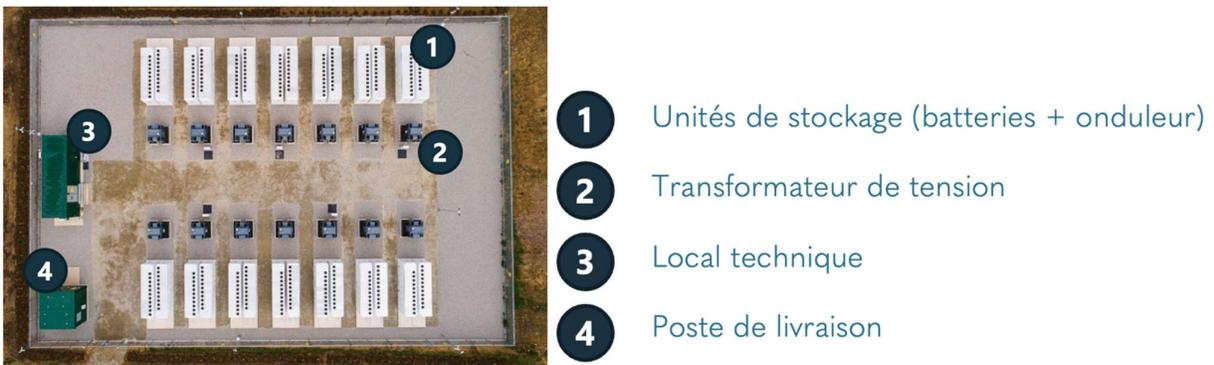
Figure 12 : Plan de principe d'une installation de stockage par batteries
