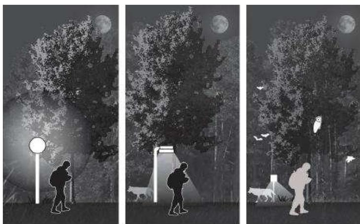
Figure 13 : Schéma des différents faisceaux lumineux. Plus la lumière est focalisée sur sa cible, moins elle affecte les espèces : le cas présenté à gauche est donc à proscrire – ©Longcore, 2016
