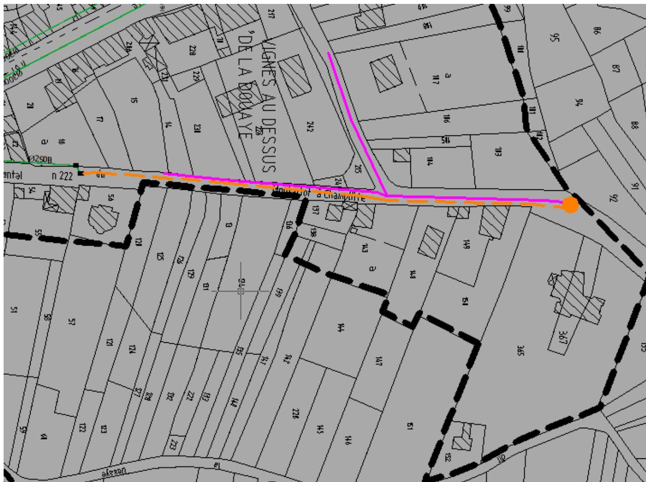
Plan de la zone et tracé envisagé pour les nouveaux réseaux (gravitaire en magenta et refoulement en orange)
