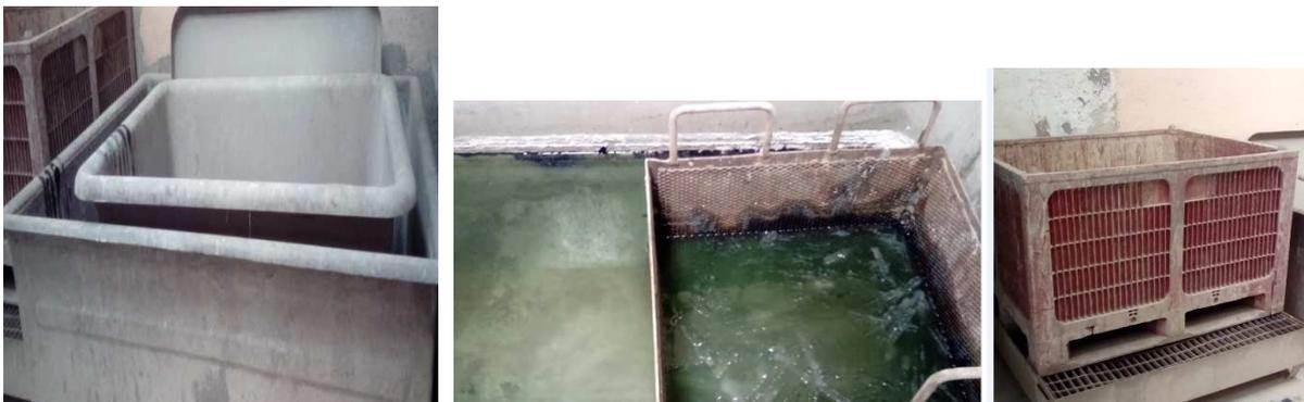
Par ailleurs, de l'eau est utilisée sur l'aire de lavage après pyrolyse. Cette aire située à l'intérieur du bâtiment dans la zone décapage chimique. Le lavage permet d'enlever les scories formées après décapage thermique sur les pièces fragiles qui ne peuvent pas subir de grenailage. Le lavage est fait au karcher à l'eau froide sans aucun additif. L'eau s'écoule au sol de l'aire de lavage pour rejoindre un système de cuves enterrées placées à l'arrière du site.
