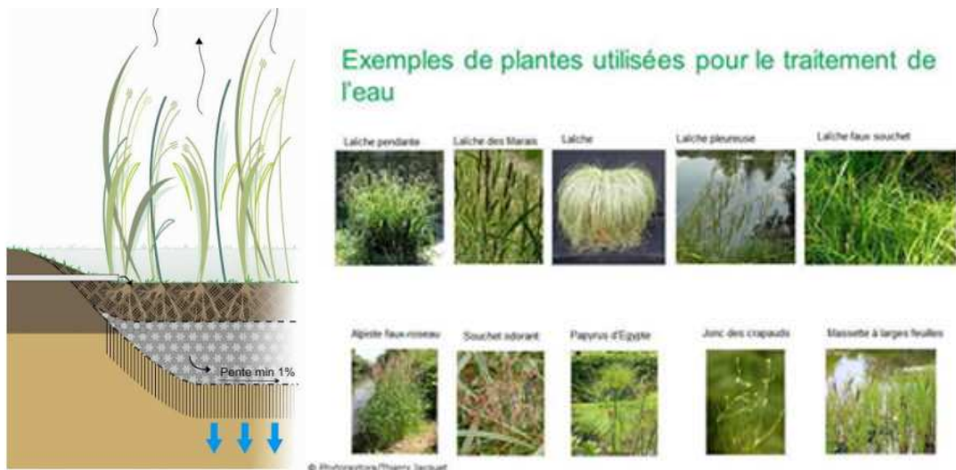
Coupe de principe d'une noue filtrantes et exemples de plantes hélophytes.
