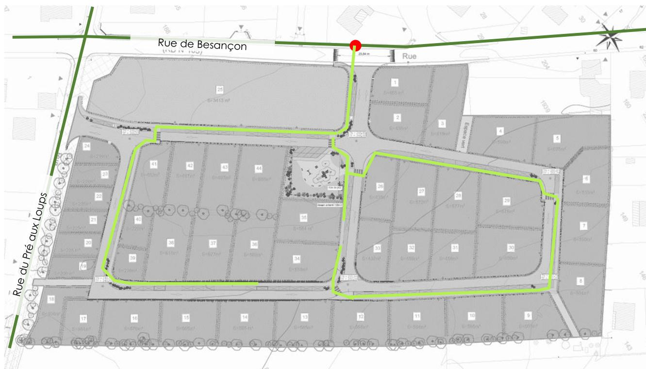
Figure 6 : Schéma du réseau de télécommunication
