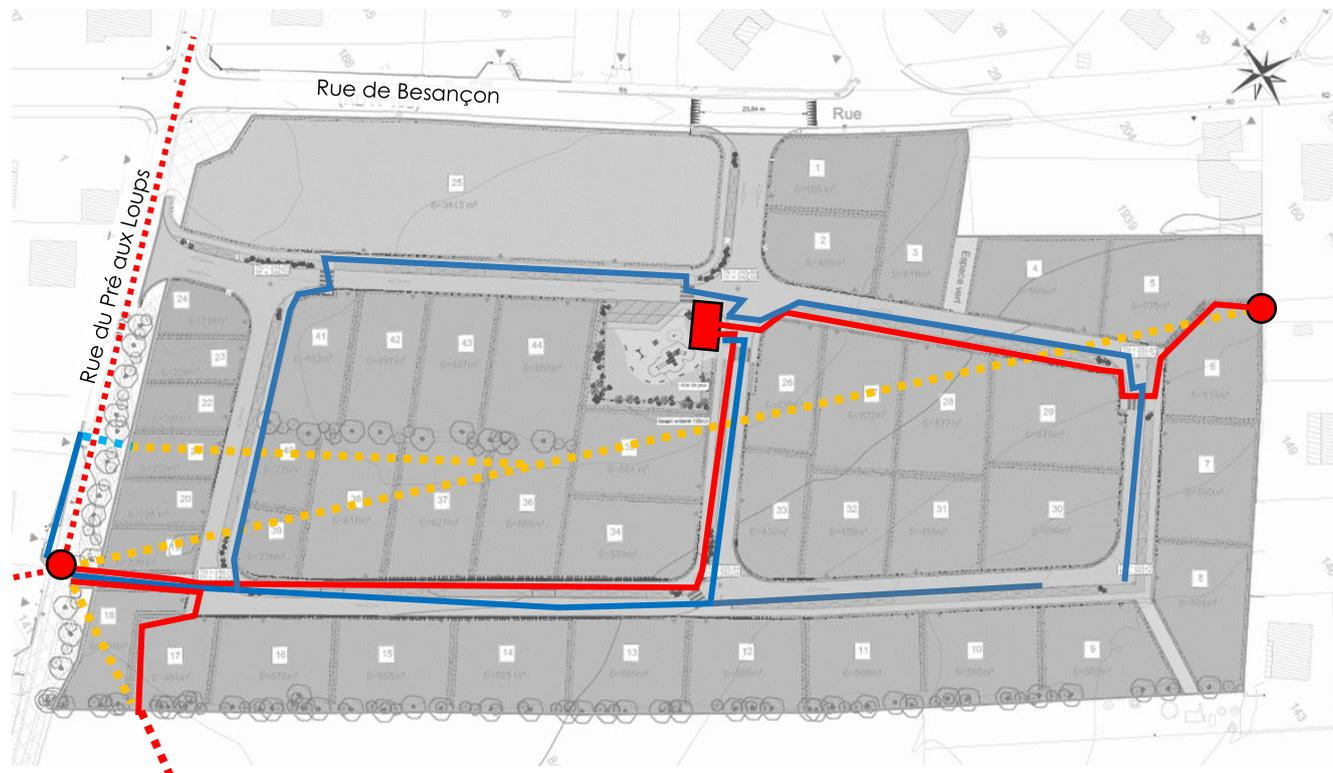
Figure 4 : Schéma du réseau de distribution d'électricité
