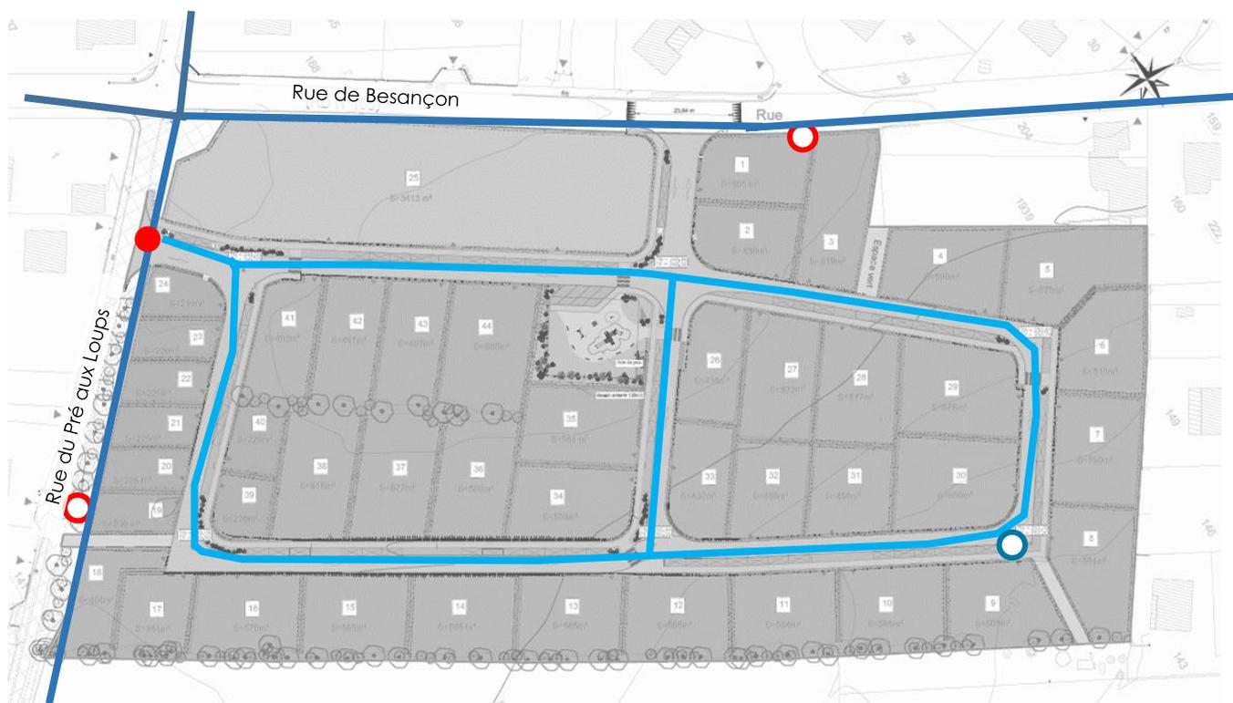
Figure 3 : Schéma du réseau d'eau potable
