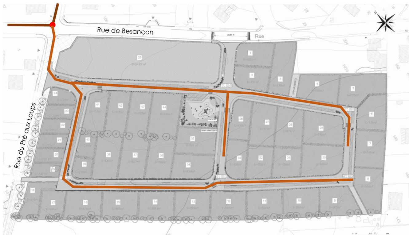
Figure 1 : Schéma du réseau d'eaux usées
