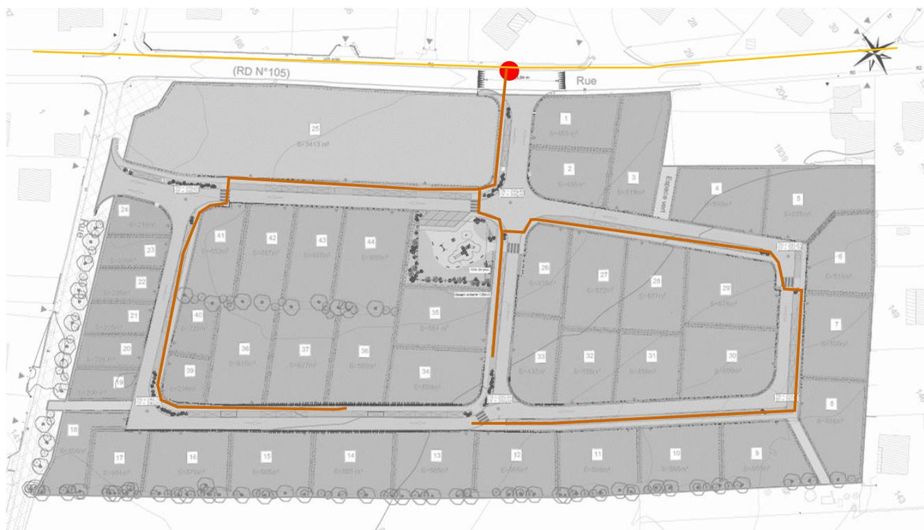
Figure 9 : Schéma du réseau GAZ
