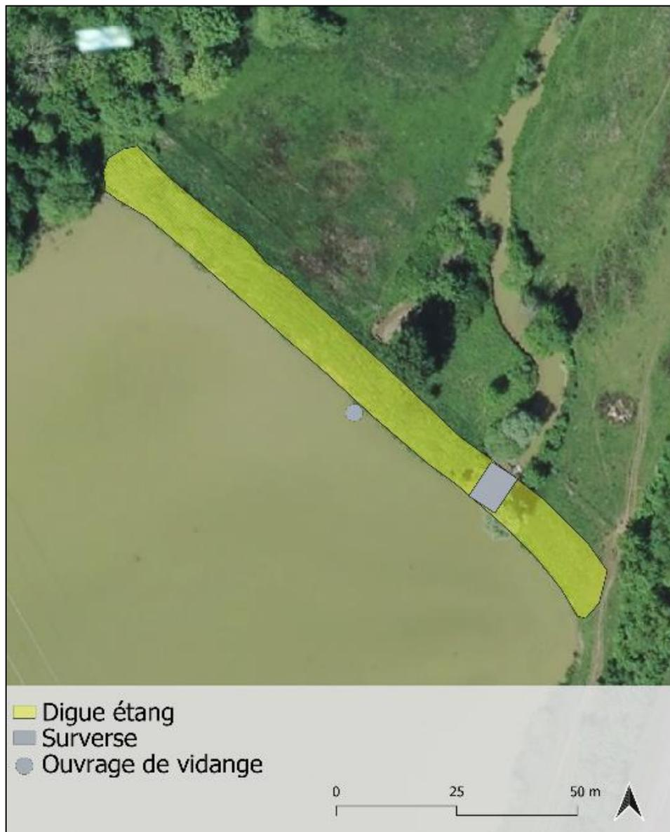
Figure 27 : Localisation de la digue, de la surverse et de l'ouvrage de vidange.
