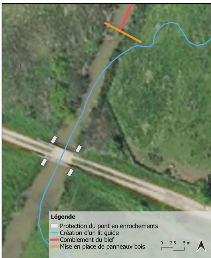
Figure 38 : Mise en place d'enrochements au droit du pont.
