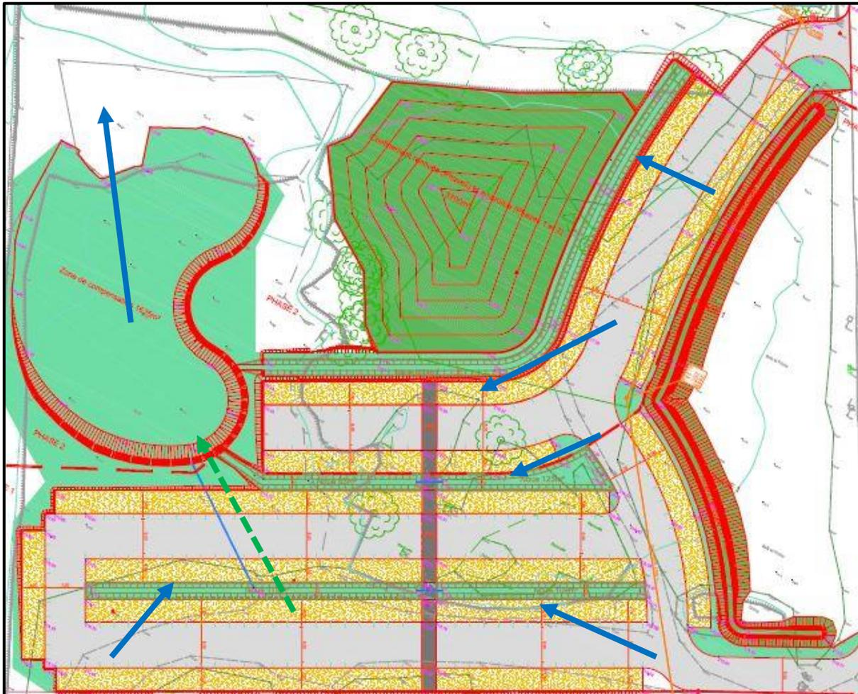
Figure 82 : Circulation des eaux pour le niveau de service N3 et N4
