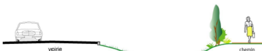
Noue en bordure de voie
