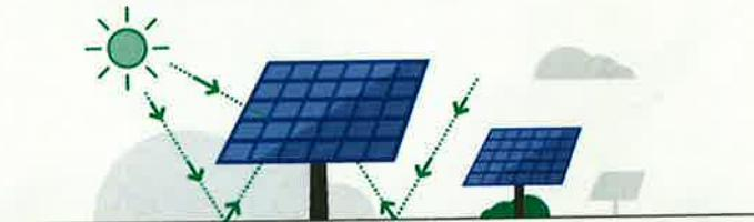
\* Les cellules solaires captent à la fois la lumière du soleil sur la face avant et arrière des panneaux photovoltaïques par réflexion du sol et de son environnement.
