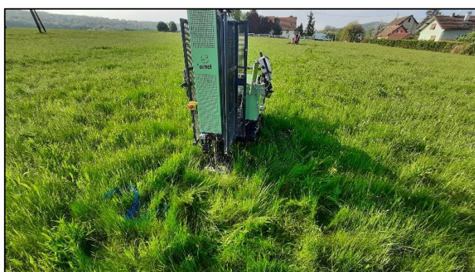
02/05/2023 : Essai au pénétromètre dynamique PD2
