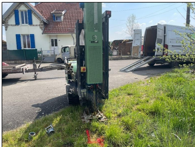
02/05/2023 : Essai au pénétrömètre dynamique PD4
