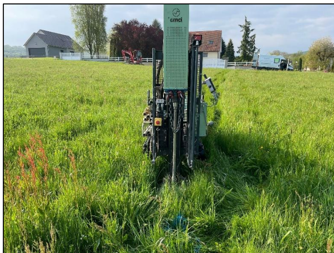
02/05/2023 : Essai au pénétromètre dynamique PD1
