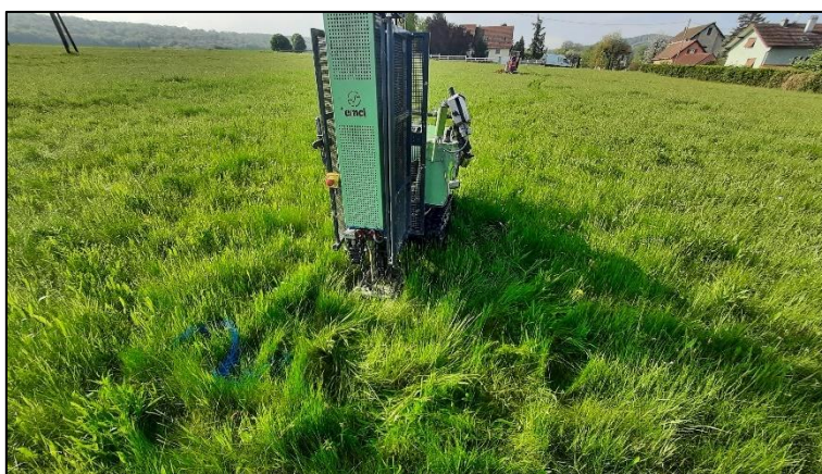
02/05/2023 : Essai au pénétromètre dynamique de type B
