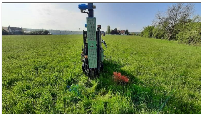
02/05/2023 : Essai au pénétromètre dynamique PD3
