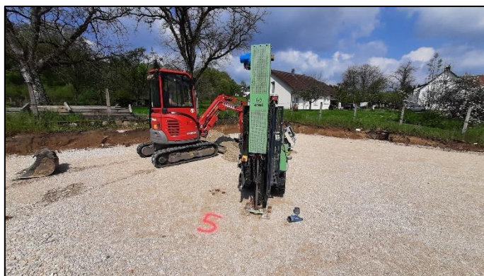
02/05/2023 : Essai au pénétrömètre dynamique PD5
