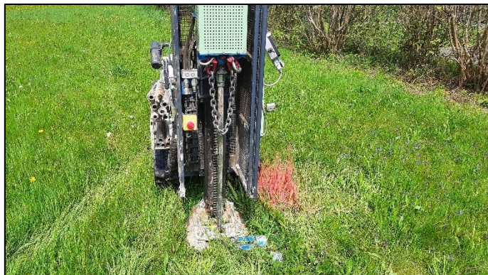
02/05/2023 : Essai au pénétromètre dynamique PD7
