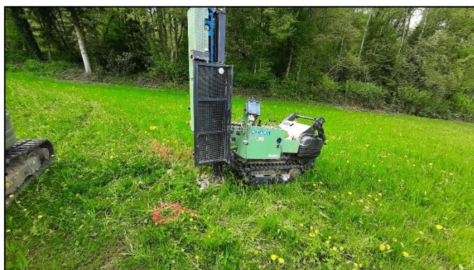
02/05/2023 : Essai au pénétrömètre dynamique PD6
