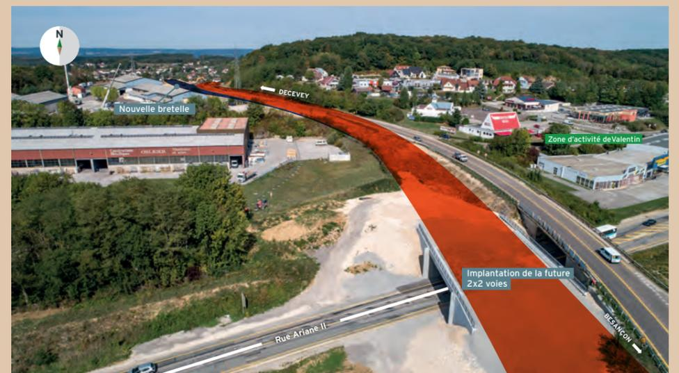
Au niveau de la zone d'activité de Valentin, les travaux de terrassement pour construire la nouvelle chaussée à 2x2 voies (qui est décalée vers l'Ouest dans le secteur) sont en cours. Lorsque les travaux de la nouvelle chaussée seront terminés et que la circulation routière aura basculé sur cette nouvelle chaussée, l'ouvrage actuel sera déconstruit (courant 2019).
