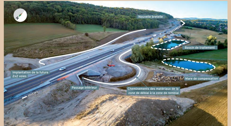
Entre la zone de déblais et la zone de remblais, les matériaux transitent le long de la RN57 par des pistes de chantier aménagées spécialement et traversent la RN57 par le **passage inférieur** aménagé en 2016-2017. À proximité de ce passage, ont été construits deux plans d'eau : une **mare de compensation**, créée dans le cadre du chantier, et un **bassin de traitement** des eaux de chaussée.
