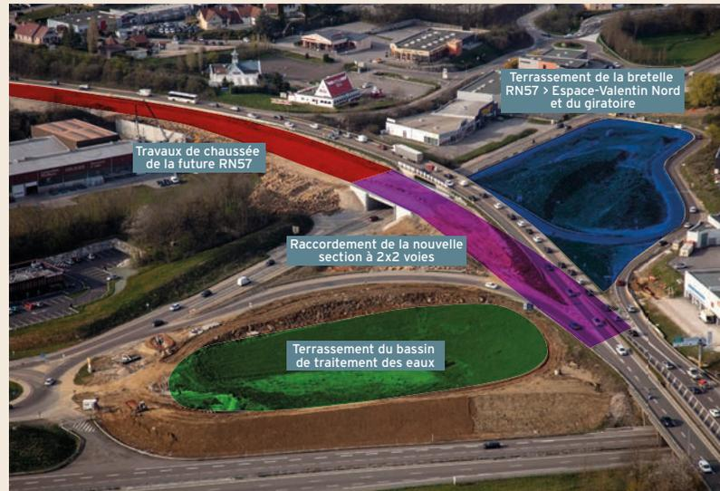
Les travaux de l'échangeur « Espace-Valentin Nord » avancent bien. Le terrassement du bassin de traitement des eaux est maintenant terminé et la construction de la future bretelle de sortie vers Miserey-Salines depuis Besançon est actuellement en cours. Cette opération nécessite le dévoiement de nombreux réseaux (eau, électricité, gaz, télécom).
