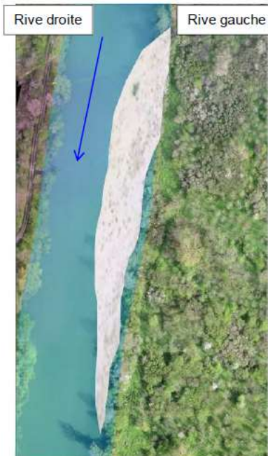
Réinjection sédimentaire sous forme d'un banc alluvionnaire
