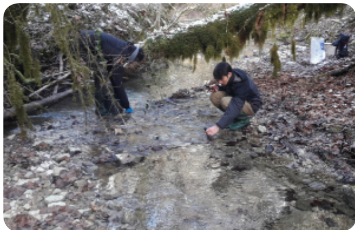
Calcul du débit par la méthode saline © D. Langlois
