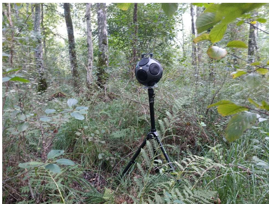
Enceinte multidirectionnelle pour le test des enregistreurs – A. Poirel, CENB
