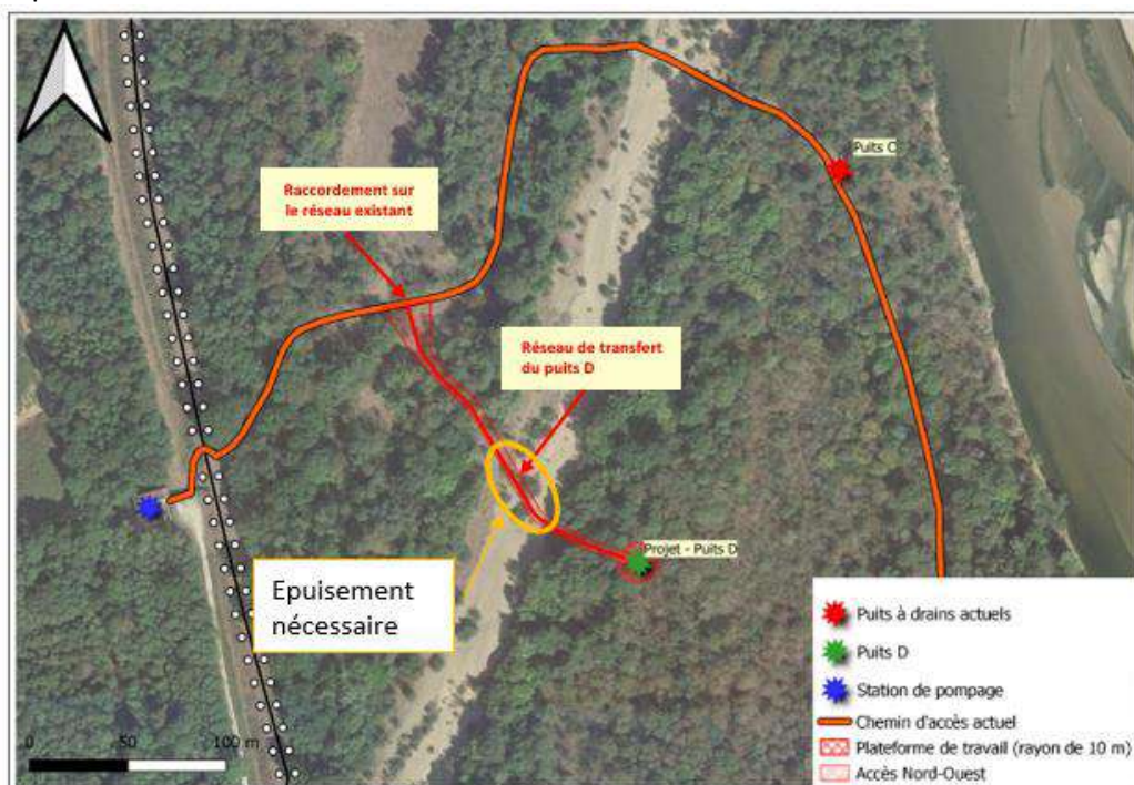
Figure 56 : Localisation de la zone à rabattre pour la pose de la canalisation
