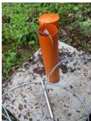
Trois autres annexes hydrauliques plus anciennes (boires) et plus déconnectées des chenaux principal et secondaires sont suivies par le biais de piézomètres équipés de sondes qui mesurent les variations de la nappe alluviale.
