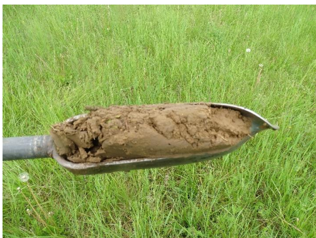
Sondage n°202 : horizon entre 35cm et 55cm
