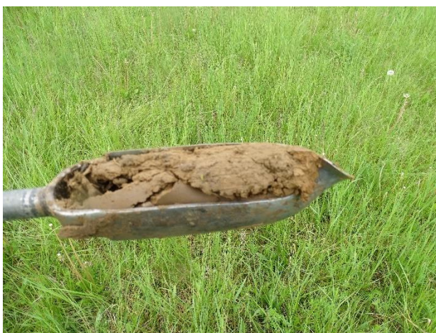
Sondage n°202 : horizon entre 60cm et 80cm
