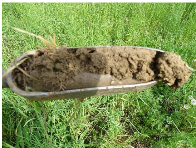
Sondage n°205 : horizon de surface
