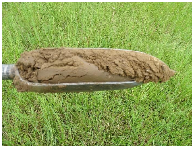
Sondage n°202 : horizon entre 15cm et 30cm
