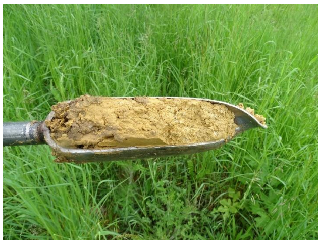
Sondage n°194 : horizon rédoxique entre 55cm et 75cm
