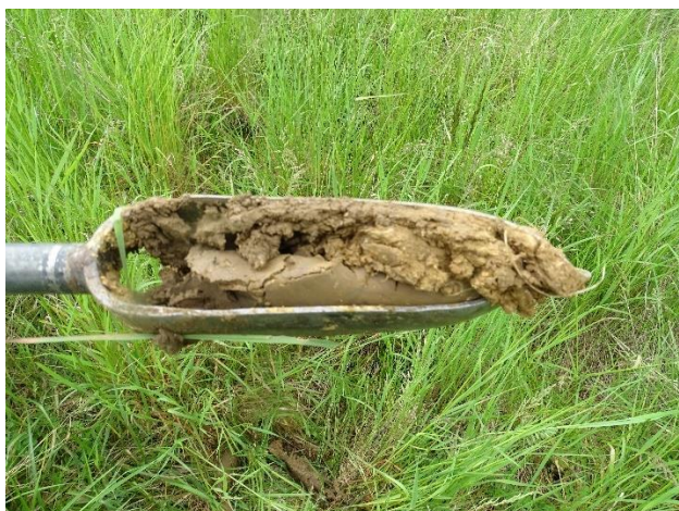
Sondage n°197 : horizon entre 15cm et 35cm
