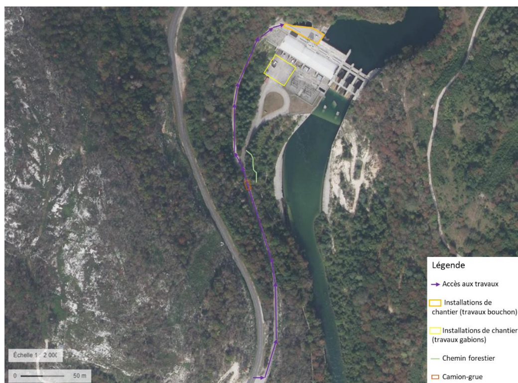
Figure 6 : Localisation des installations de chantier et des accès pour les travaux de confortement du bouchon de la prise d'eau et de renforcement des gabions
