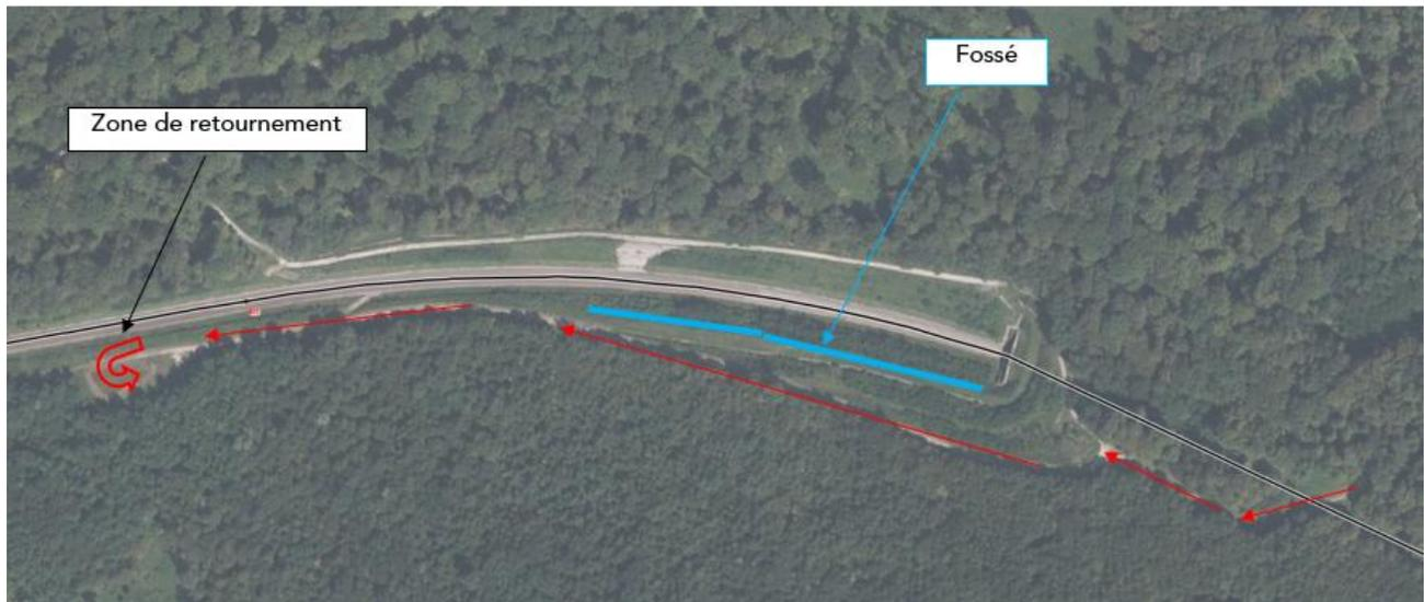
Figure 1 : Plan de circulation des engins pour le fossé de Genevreuille (flèches rouges)
