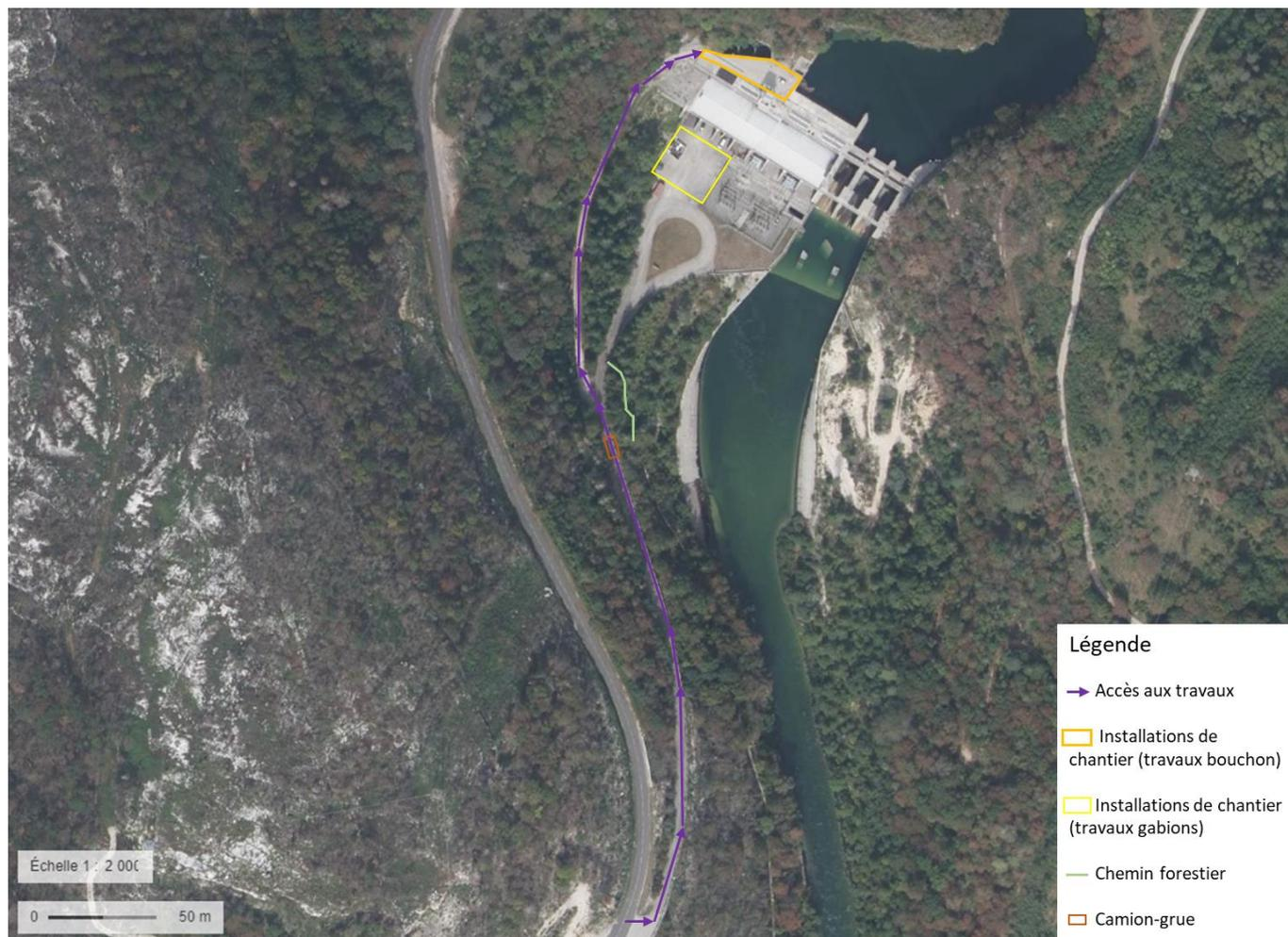
Figure 6 : Localisation des installations de chantier et accès pour les travaux de confortement du bouchon de la prise d'eau et de renforcement des gabions
