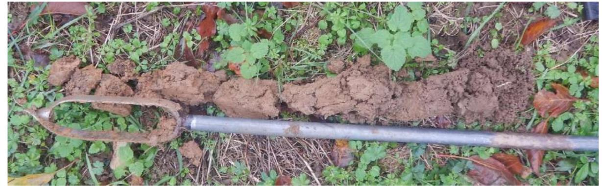
Photo 8 : Exemple de carottage sur une profondeur de 70 cm avec apparition de traces rédoxiques à 50 cm
