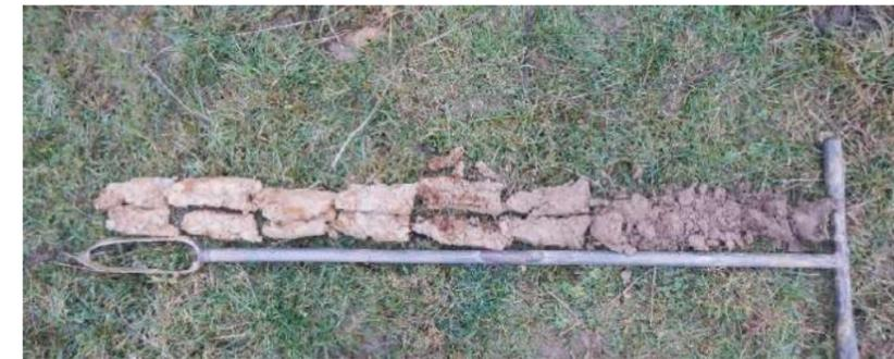
Photo 2 : Exemple de carottage sur une profondeur de 120 cm (Source : AEPE-Gingko)
